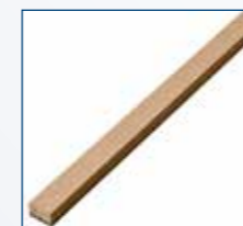
EQ POR Klimamodul Rahmenholz 1000 x 45 x 20 mm (LxBxH) zur Verlegung an Wänden zwischen Randdämmstreifen und System- oder Füllelementen sowie in Türdurchgängen, zur Optimierung der Lastabtragung
